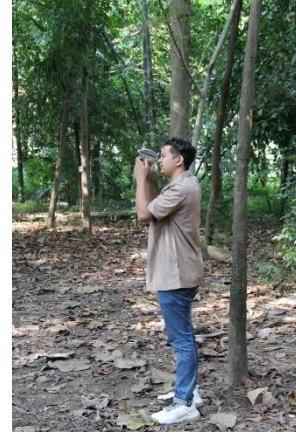
Pengukuran tinggi pohon menggunakan alat Haga Hypsometer
