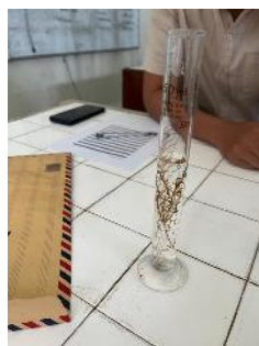
Gambar 15. Pengukuran Volume Akar
