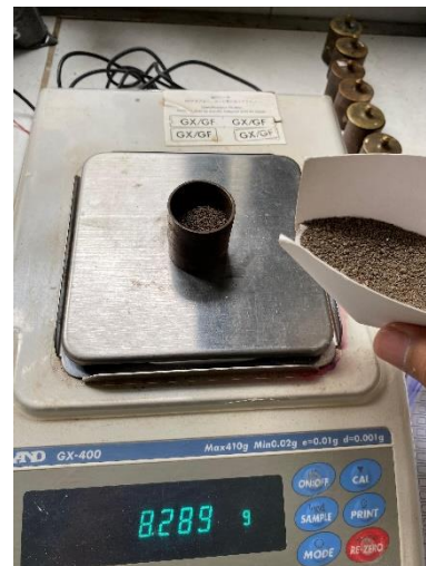
Gambar 9. Pengukuran volume akar dan kadar lengas tanah
