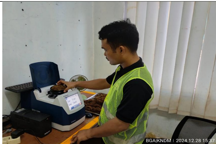
Menganalisis oil losses pda fibre menggunakan alat Foss NIR
