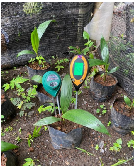
Pengukuran pH tanah & kelembaban
