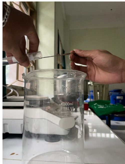
Pembuangan cairan maserator dan meninggalkan sampel serat yang ditahan dengan jarum preparat
