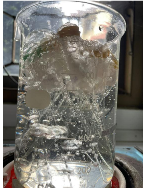
Kayu sudah membengkak atau “swelling” dan lignin sudah larut
