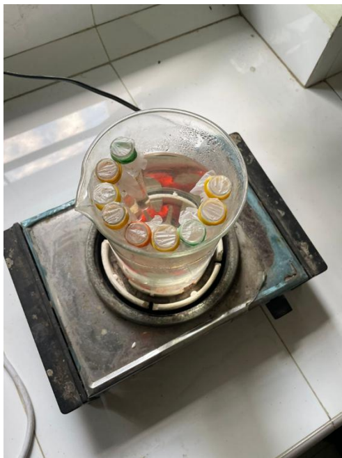
pemasakan sampel serat kayu selama kurang lebih 4 jam
