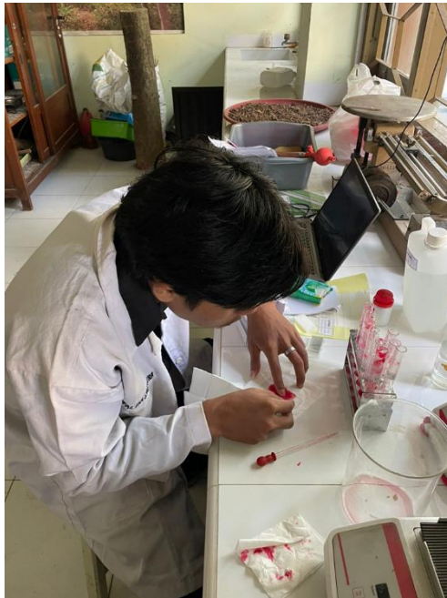
membuang air yang terdapat pada sampel serat dengan menggunakan kertas tisu
