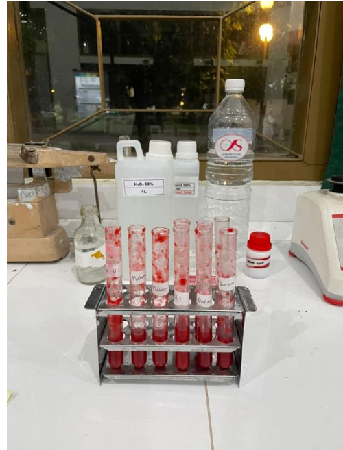
Sampel serat didiamkan selama kurang lebih 24 agar mewarnai serat secara sempurna
