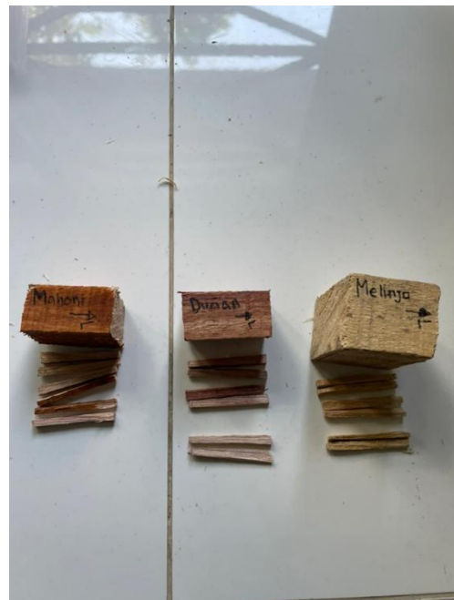
Membuat kayu menjadi balok kecil berukuran panjang 3 cm, lebar 0,2 cm dan tinggi 0,3 cm. Ukuran panjang mengikuti arah longitudinal (arah sumbu pohon).
