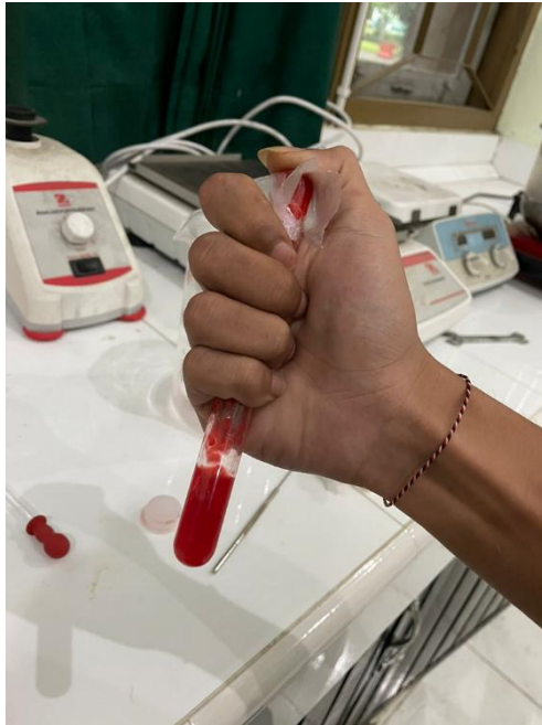
Mengojok kemabali sampel serat yang sudah diberikan safranin agar merata pada seluruh serat
