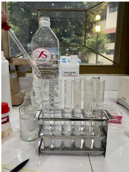
Memberikan aquadesah 1/3 tabugn reaksi setelah proses pencucian serat selesai
