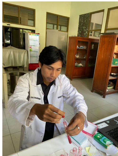
Mengambil sampel serat menggunakan pipet hisap yang selanjutnya diletakkan pada objek glass
