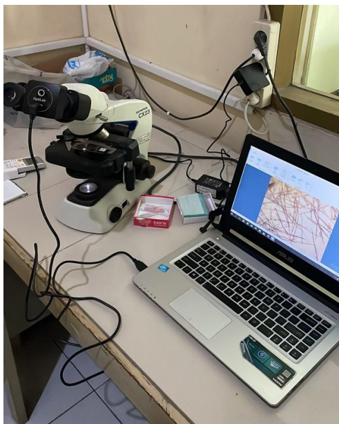
Persiapan pemotretan dengan mikroskop dan disambungkan dengan optilab camera dan mengambil sampel gambar yang selanjutnya akan diukur
