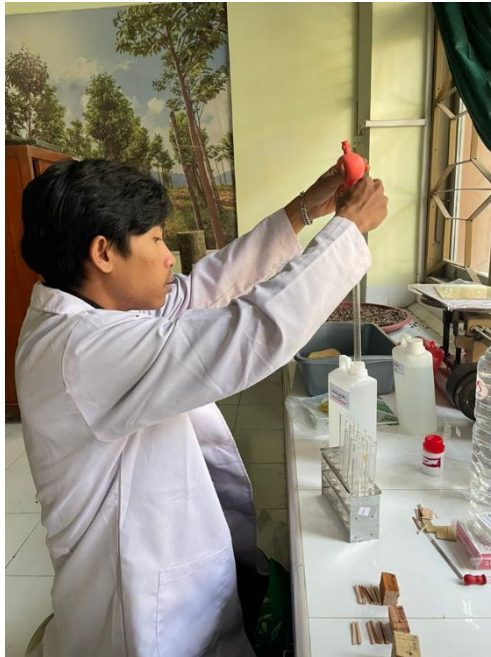
Proses pembuatan cairan maserator Asam asetat glasial dan Hidrogen peroksida
