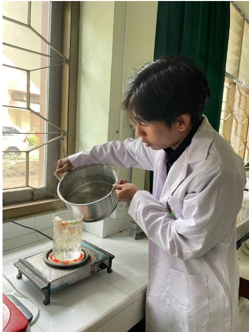
Penambahan air panas ke gelas piala yang hilang akibat penguapan selama proses pemasakan sampel serat
