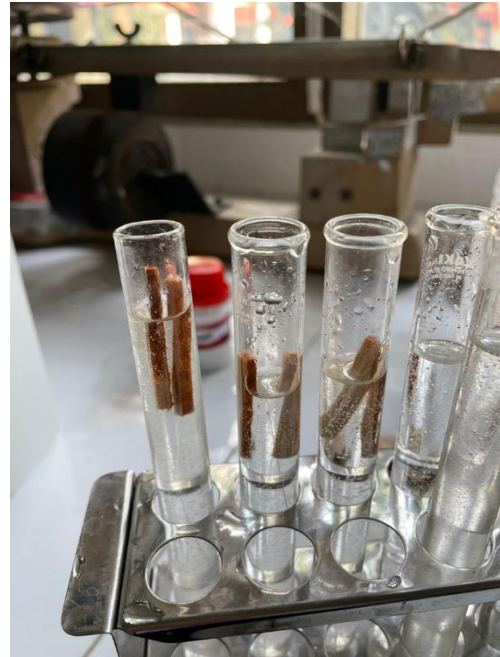
Memasukkan sampel kayu kedalam cairan maserator
