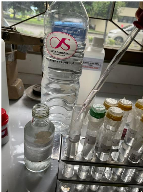
Pembersihan sampel serat dari cairan maserator dengan cara mencuci sampel serat menggunakan aquadesah atau air suling
