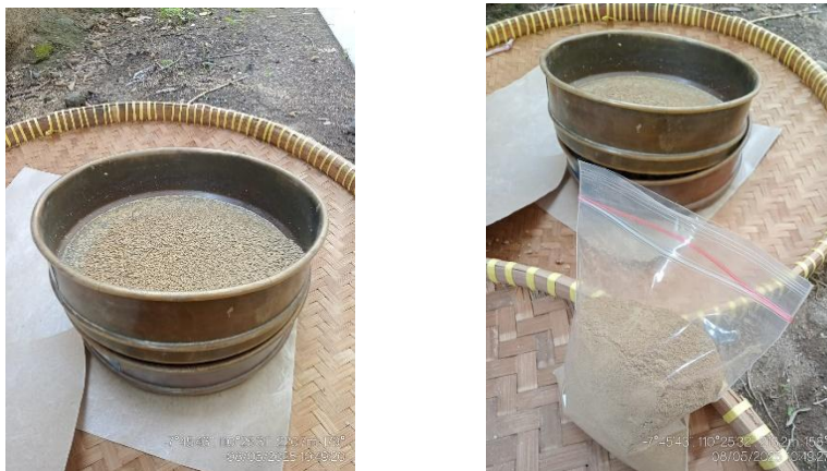
Gambar 2. pengayakan sampel tanah
