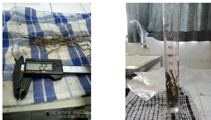
Gambar 5. pengukuran diameter dan berat volume akar
