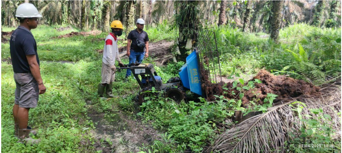
Proses pengantaran jangjang kosong menggunakan PWB 300 modifikasi ke setiap titik tanaman yang diletakkan di antara pokok kelapa sawit.
