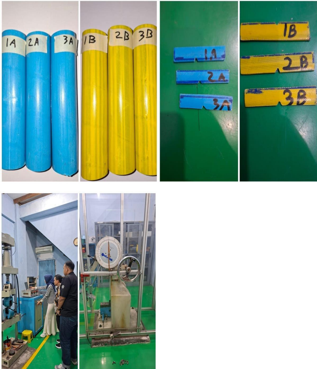
Lampiran 3. Spesimen uji bending dan impak
