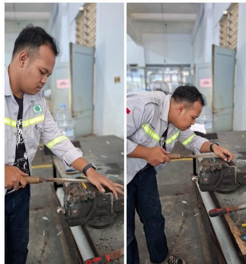
Pembutan v notch pengujian impak
