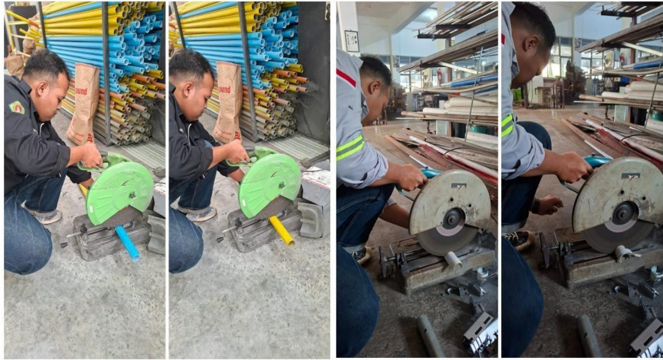
Memotong pipa komposit galah carbon dan fiberglass
