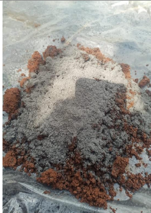
Pencampuran tanah dan abu boiler
