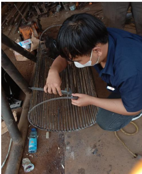
Foto pengukuran jarak kisi – kisi
