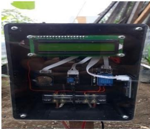
Gambar 4.3 Rangkain Kontrol Irigasi Otomatis Tampak Depan Box Elektronik
