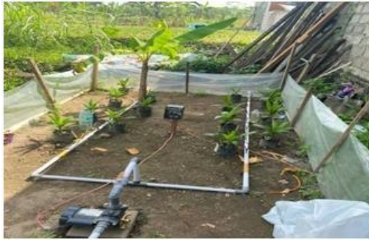
Gambar 4.1 Instalasi fertigasi Otomatis Pembibitan Kelapa Sawit Sensor Kelembapan Tanah
