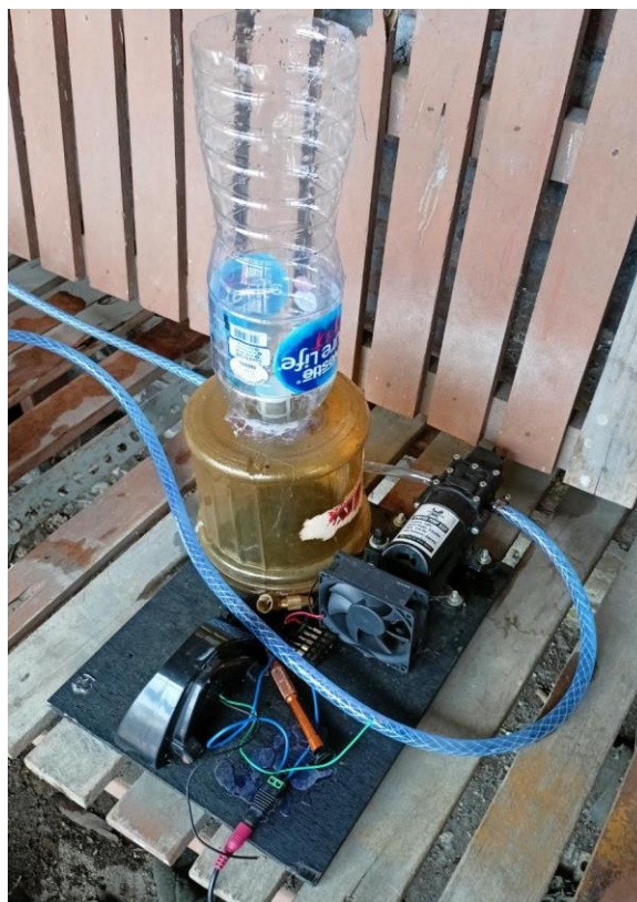
Gambar 4.3 Proses Kalibrasi Alat Sprayer Pengkabut Mini
