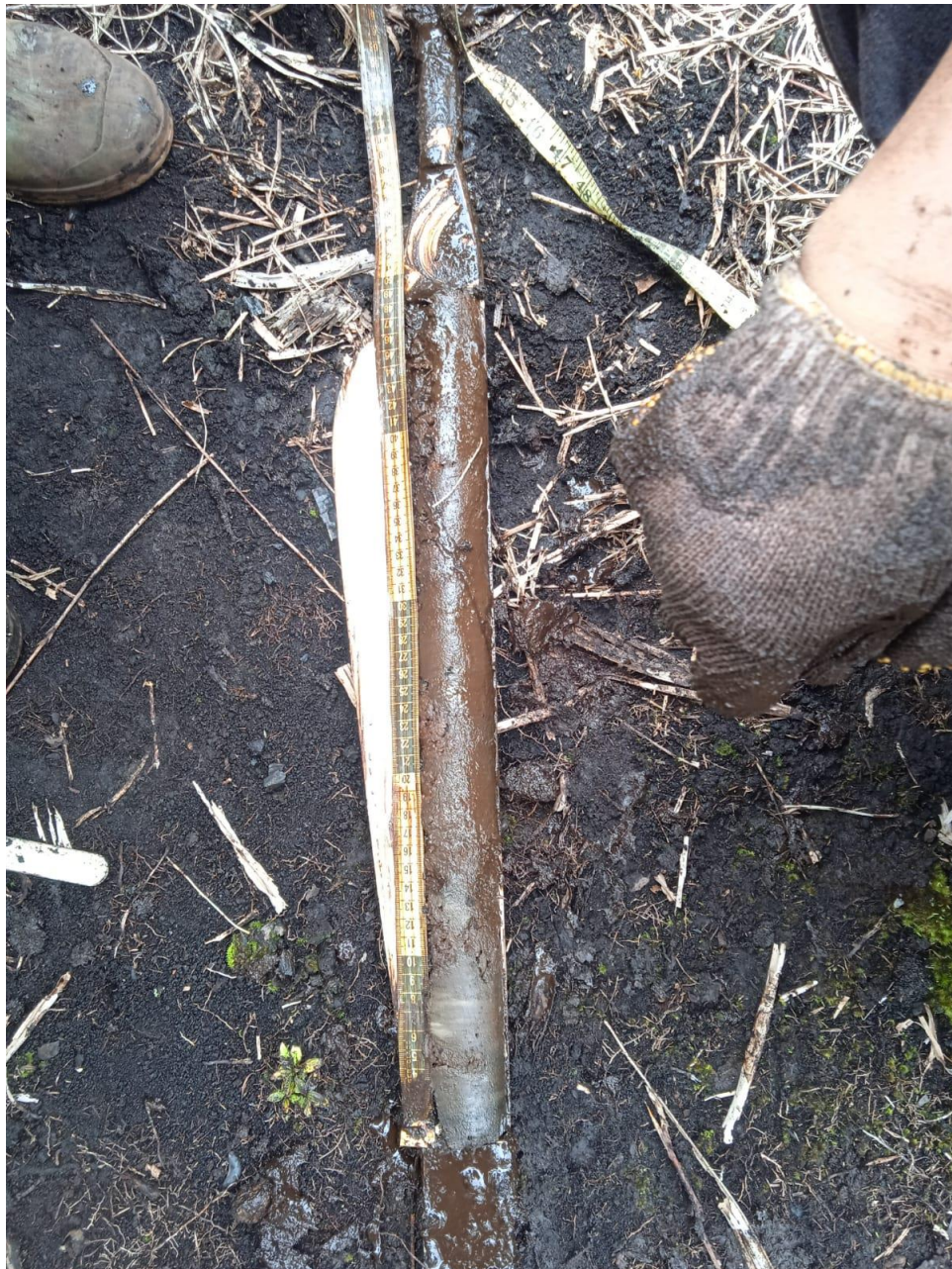
Lampiran 3.8 Pengukuran Ketebalan Sampel Gambut
