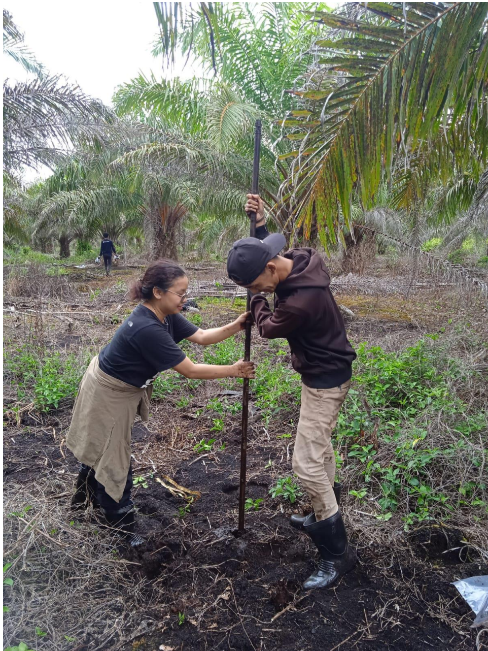
Lampiran 3.7 Pengambilan Sampel Gambut menggunakan Bor Split-Tube
