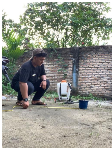
Gambar 5. Pengukuran Lebar Semprot
