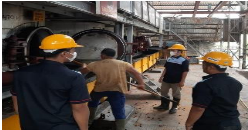
Gambar 4. 4 Mengeluarkan TBS dari tabung sterilizer dengan gancu.
