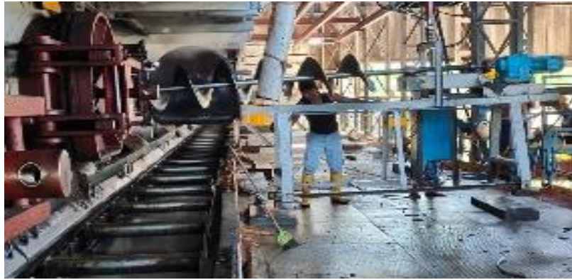
Gambar 4. 3 Mengeluarkan TBS dari tabung sterilizer dengan alat screw conveyor.
