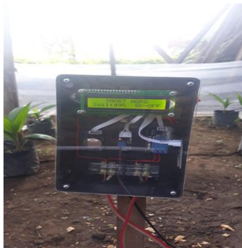
Gambar 8. Mengaplikasikan sistem irigasi otomatis dilapangan
