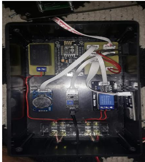
Gambar 4. Rangkaian sensor pada PCB
