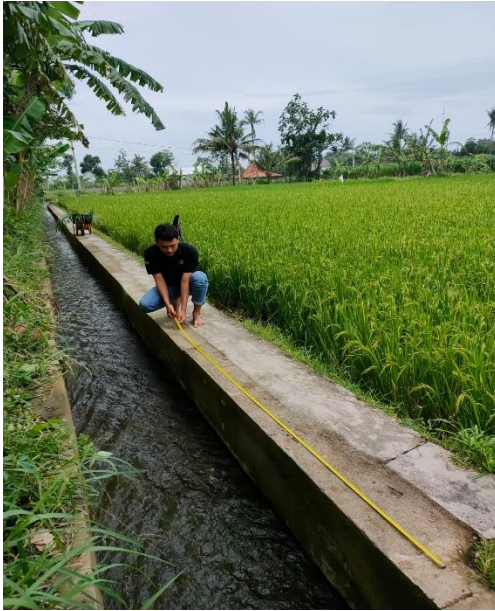
Lampiran 5. Foto mengukur panjang lintasan aliran dan Lebar penampang
