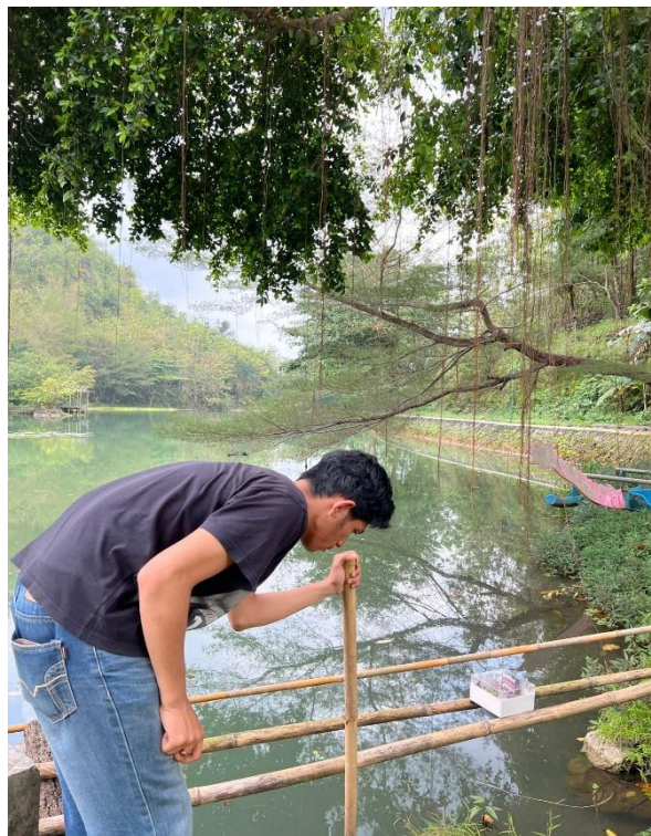
Melakukan pengambilan data jarak actual antara sensor dan muka air
