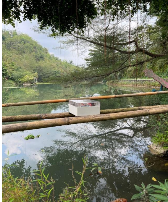
Pemasangan AWLR diatas permukaan embung tanpa terhalang objek agar alat dapat merekam
