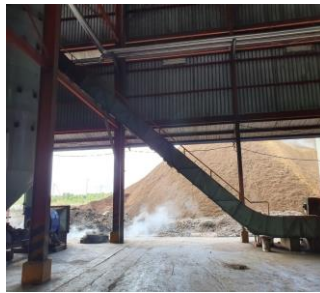
Gambar 4.4 l Mesin conveyor tidak memiliki tutup
