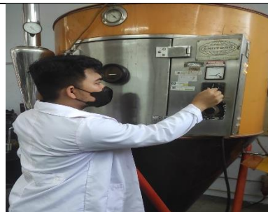
Mengatur suhu inlet dan outlet pada spray drying
