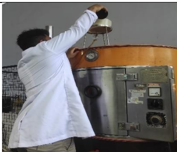
Penuangan ekstrak kedalam wadah spray drying
