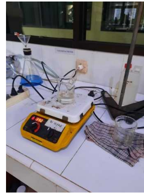
Pecampuran bahan menggunakan magnetic stirrer
