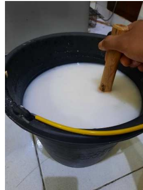
Perendaman biji keret menggunakan larutan air kapus \text{CaCO}_3
