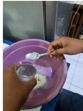
Suspensi kitosan dengan aquades (1:100)
