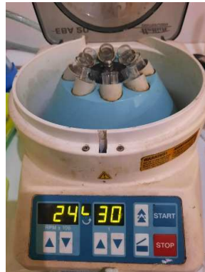
Isolat protein dengan metode sentrifugasi
