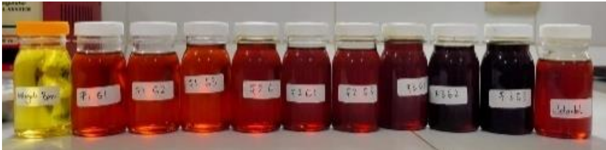
Gambar 2. Minyak goreng baru, Sampel hasil pemurnian minyak jelantah, dan minyak jelantah sebelum dimurnikan
