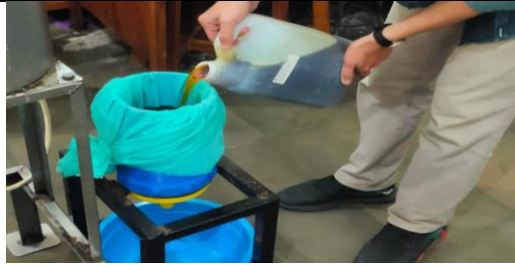
Penyaringan minyak jelantah
