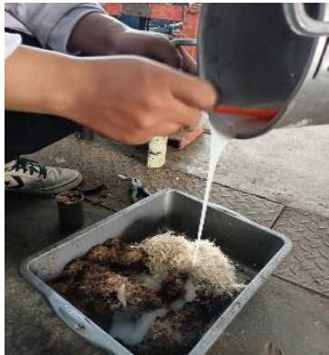
3. pencampuran perekat terhadap fiber dan ampas tebu
