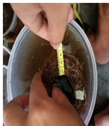
6. Pengukuran pengembangan ketebalan setelah direndam 24 jam
