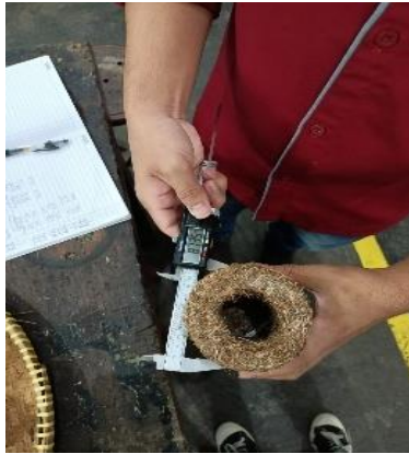
1. Analisis kerapatan yang menggunakan jangka sorong digital
