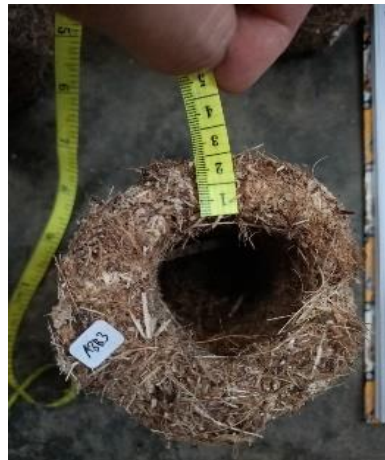
3. Analisis pengembangan ketebalan yaitu dengan mengukur tebal sampel sebelum direndam 24 jam
