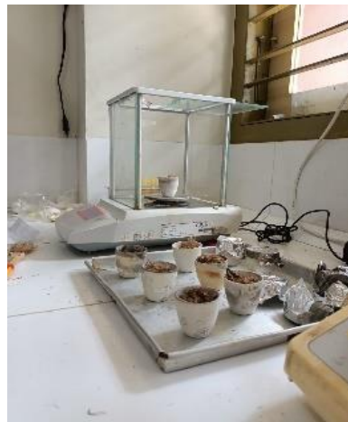
2. Analisis kadar air pada pot organik
