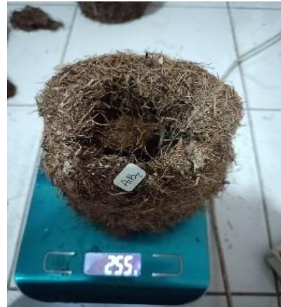
7. Penimbangan pot organik setelah direndam 24 jam untuk mengetahui daya serap air
