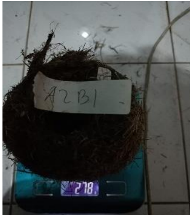
7. Penimbangan pot organik setelah direndam 24 jam untuk mengetahui daya serap air
