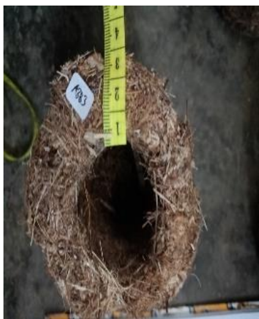
3. Analisis pengembangan ketebalan yaitu dengan mengukur tebal sampel sebelum direndam 24 jam
