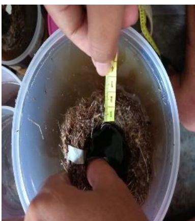
6. Pengukuran pengembangan ketebalan setelah direndam 24 jam
