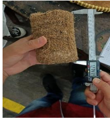
1. Analisis kerapatan yang menggunakan jangka sorong digital
