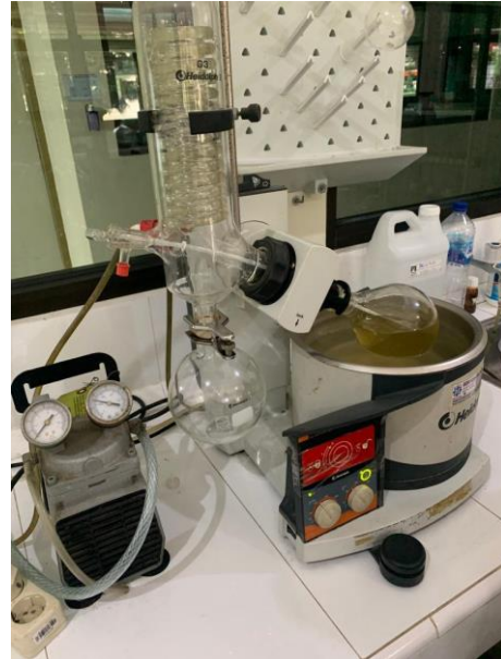
Proses penguapan ter-butanol.
