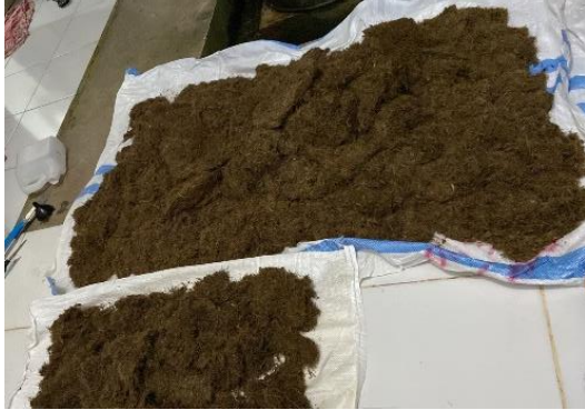
Membersihkan dan mengeringkan fiber kelapa sawit
