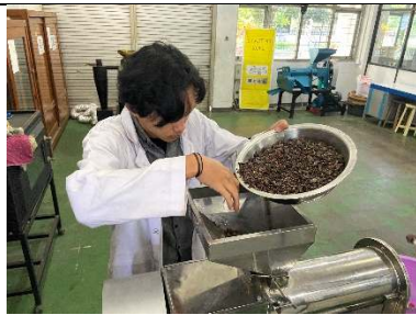
Pemastaan biji kakao menggunakan mesin pemasta
