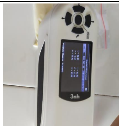
Analisis warna menggunakan colorimeter
