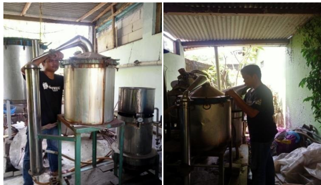
Proses penutupan ketel bahan baku pada metode uap dan kukus
