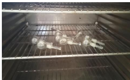
Proses pengovenan piknometer
