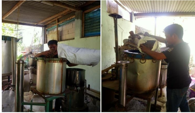
Proses pemasukan bahan baku ke ketel bahan baku pada metode uap dan kukus
