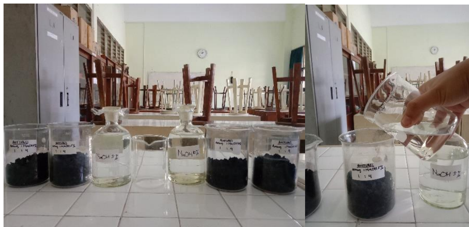
Gambar Proses Aktivasi Arang dengan Menggunakan Larutan NaOH dengan Perlakuan Variasi Konsentrasi Bahan Aktivator 5% dan 10 %
