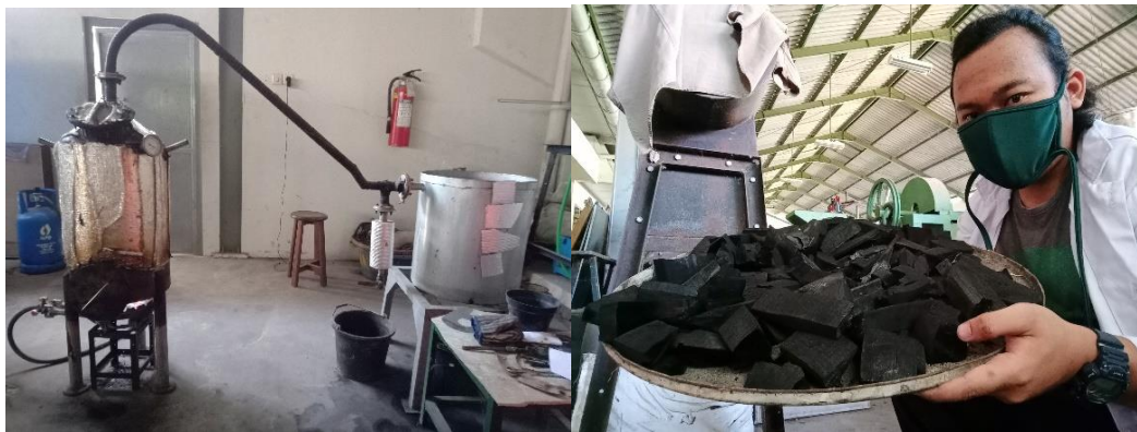
Gambar Proses Pembuatan Arang dengan Menggunakan Reaktor Pirolisis Berikut Arang yang Dihasilkan
