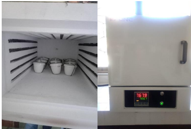
Gambar Proses Aktivasi Arang Secara Fisika dengan Menggunakan Furnace pada Suhu 800 °C
