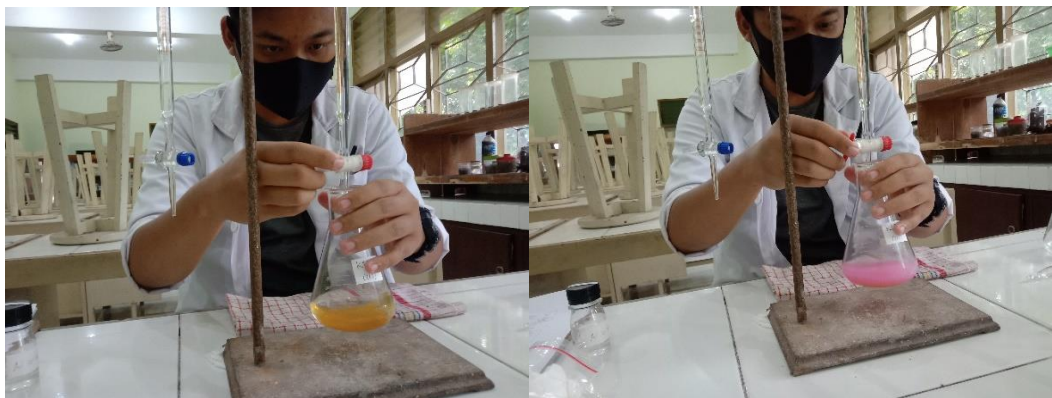
Gambar Proses Analisa Bilangan Asam Minyak Goreng Bekas
