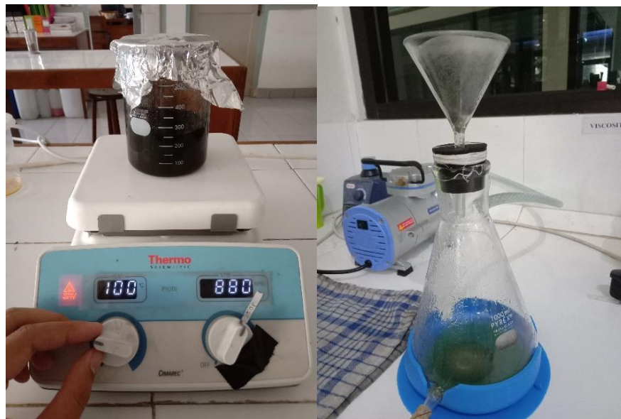
Gambar Proses Aplikasi Arang Aktif Kedalam Minyak Goreng Bekas dengan Menggunakan Hot Plate Magnetic Stirrer Untuk Kemudian Difiltrasi Menggunakan Pompa Vakum
