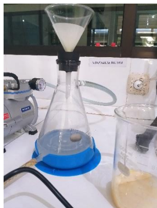
Pemisahan menggunakan vakum filter
