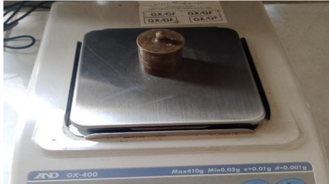
Gambar 25. Timbang Botol + Tanah + Tutup Sebelum Dioven (Analisis Kadar Lengas)
