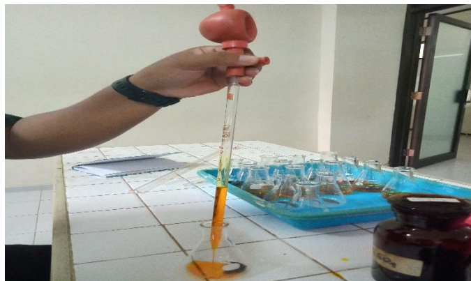
Gambar 37. Sampel Tanah Dimasukan Tabung Ukur dan Ditambah \text{K}_2\text{Cr}_2\text{O}_7 & \text{H}_2\text{SO}_4 (Analisis Bahan Organik)
