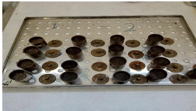
Gambar 26. Persiapan Untuk Masuk Oven (Analisis Kadar Lengas)
