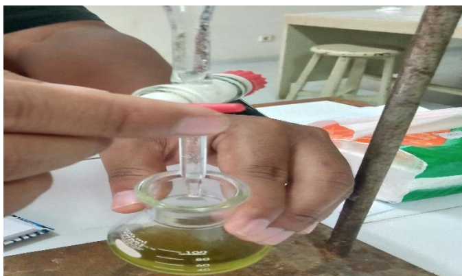
Gambar 41. Dititrasi Menggunakan \text{FeSO}_4 (Analisis Bahan Organik)
