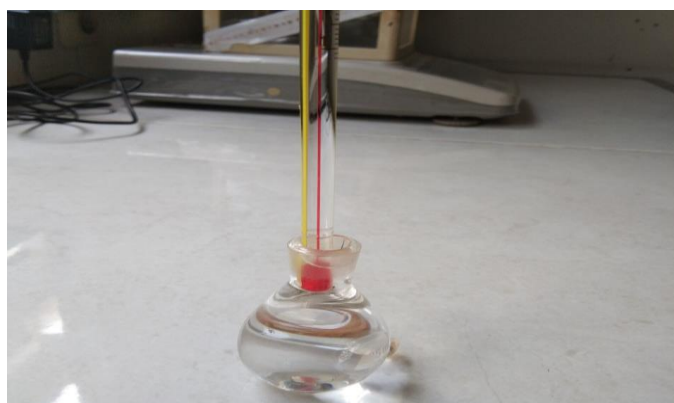
Gambar 33. Ukur Suhu Air Dalam Piknometer (Analisis Berat Jenis)
