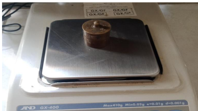
Gambar 27. Timbang Botol + Tutup + tanah Setelah Dioven (Analisis Kadar Lengas)
