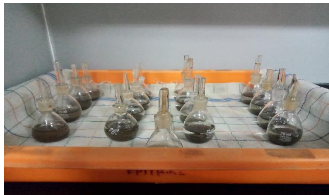
Gambar 35. Pycnometer + Tanah + Air + Tutup Dibiarkan Semalam (Analisis Berat Jenis)
