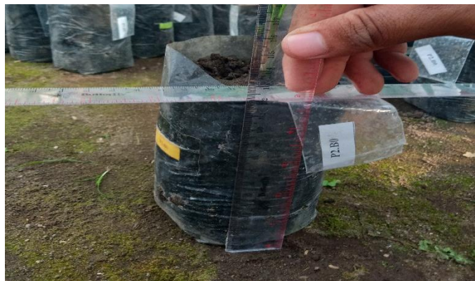
Gambar 30. Pengukuran Tinggi Media (Analisis Berat Volume)
