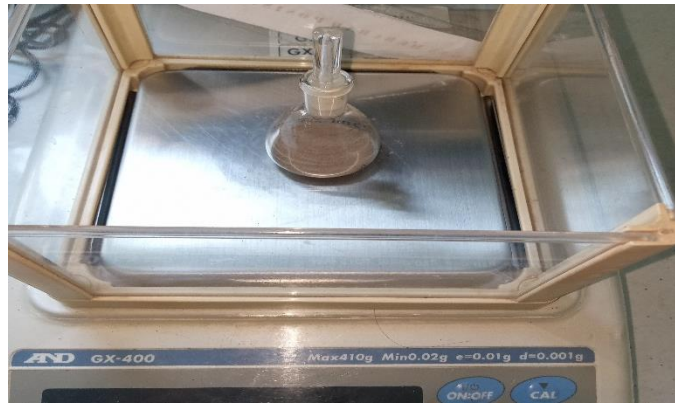
Gambar 34. Timbang Pycnometer + Tanah + Tutup (Analisis Berat Jenis)
