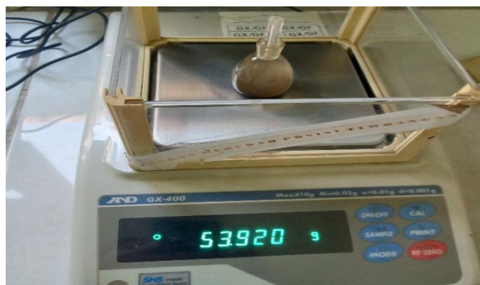
Gambar 36. Timbang Pycnometer + Tanah + Air + Tutup (Analisis Berat Jenis)
