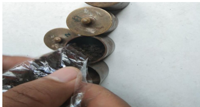
Gambar 24. Mengisi Botol Dengan Sampel Tanah (Analisis Kadar Lemas)
