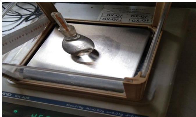
Gambar 32. Timbang Piknometer + Tutup + Air (Analisis Berat Jenis)
