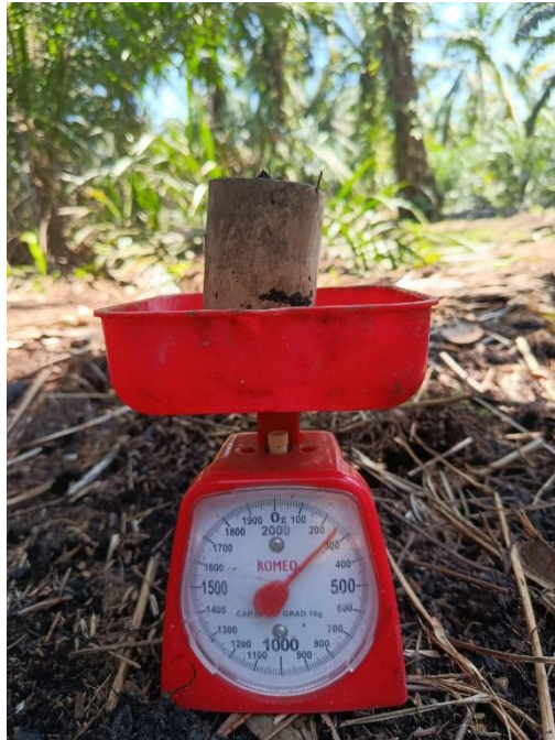
Lampiran 9. Penimbangan tanah gambut yang tidak dibakar
