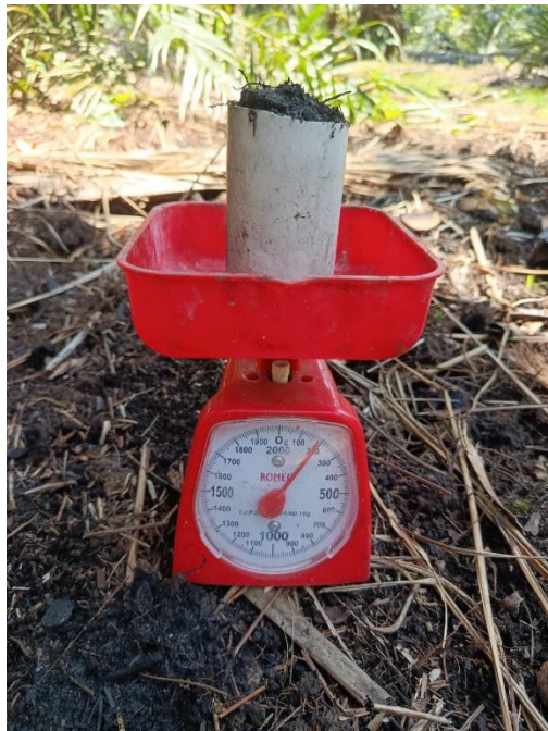
Lampiran 8. Penimbangan tanah gambut yang sudah terbakar
