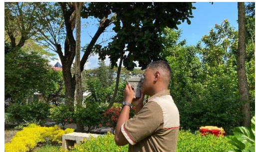
Pengukuran tinggi menggunakan Hagahypsometer
