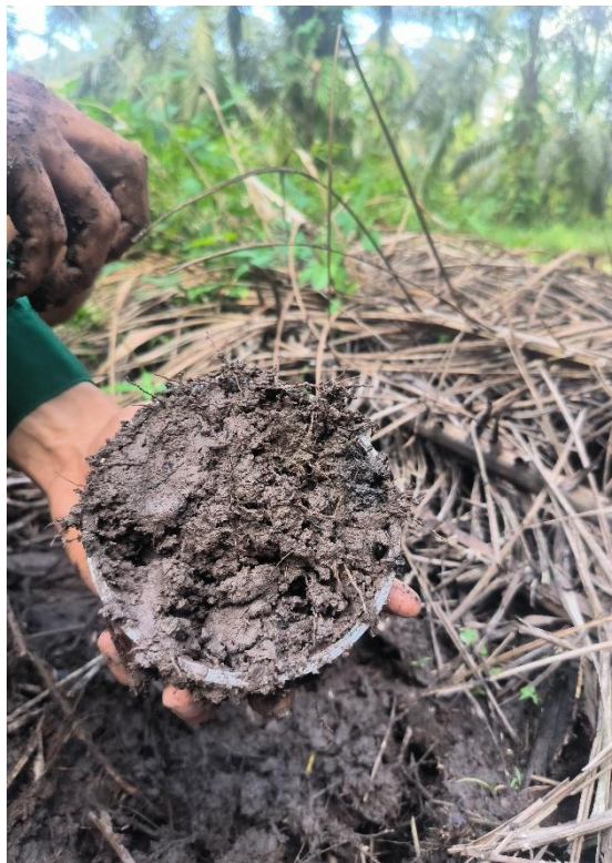
Gambar 11. Sampel Tanah Dalam Ring Sampel
