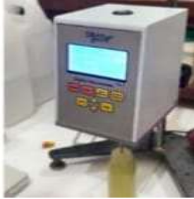
Uji Visikosis menggunakan viscometer
