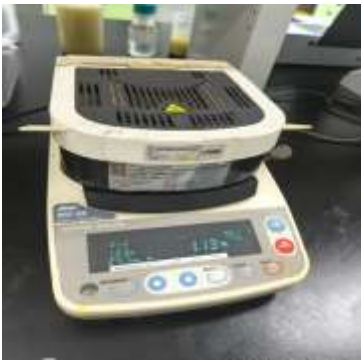
Moistur analyzer untuk uji kadar air
