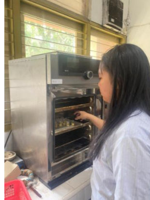
Analisis Kadar Air Metode Oven
