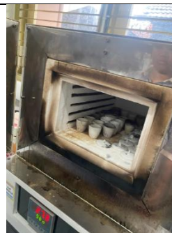
Analisis Kadar Abu Metode Muffle
