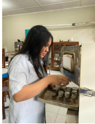
Memasukan Cawan Kedalam Muffle
