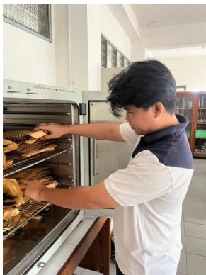
Lampiran 16. Pengovenan bibit untuk mengukur berat kering selama 24 jam
