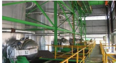
Gambar 3. Sterilizer vertikal ( Dokumentasi Pribadi, 2024)
