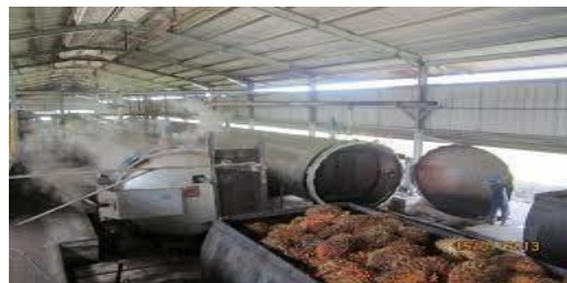
Gambar 2. Sterilizer konvensional horizontal (Dokumentasi Pribadi, 2024)
