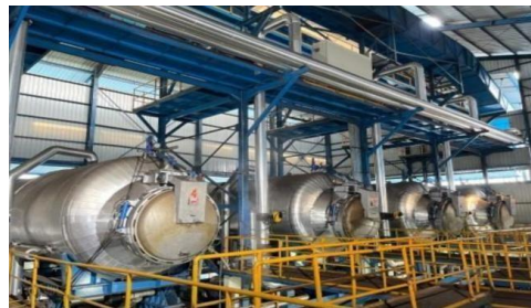
Gambar 4. Tilting sterilizer horizontal ( Dokumentasi Pribadi, 2024)
