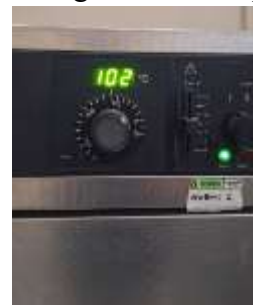
Atur suhu ke 105°C dan biarkan selama 24 jam
