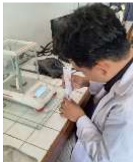
Timbang 1 gr (Olsen) atau 2,5 gr (Bray) sampel ke dalam erlenmeyer
