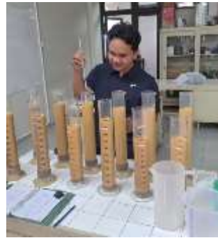
Pengukuran suhu dan hidrometer kembali setelah 2 jam
