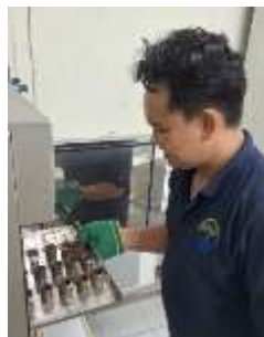
Proses pengeluaran sampel dan kemudian menimbang kadar lengas sampel
