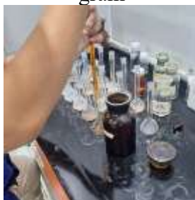
Kemudian sampe di tambah K_2Cr_2O_7 1N, H_2SO_4 Pekat sebanyak 10 ml
