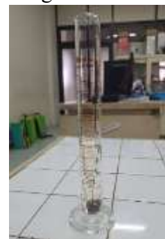
Kemudian masukan ke gelas ukur untuk mengetahui kenaikan volume air
