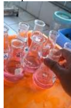
Titrasi sampai merah muda, kemudian catat volume titrasi
