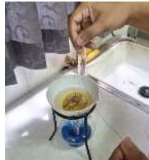
Proses pencelupan sampel tanah kedalam lilin yang sudah dicairkan dengan suhu 60^{\circ}\text{C}
