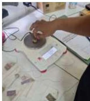
Setelah di lapisi lilin timbang kembali sampel
