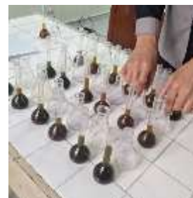
Dinginkan selama 30 menit, dan tambahkan 5 ml H_3PO_4 85% dan 1 ml diphenyl-amine dan aquades hingga batas tera
