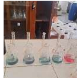
Tampung hasil destilasi dalam erlenmeyer yang berisi 5 ml asam borat 1% sampai volume 50-75 ml
