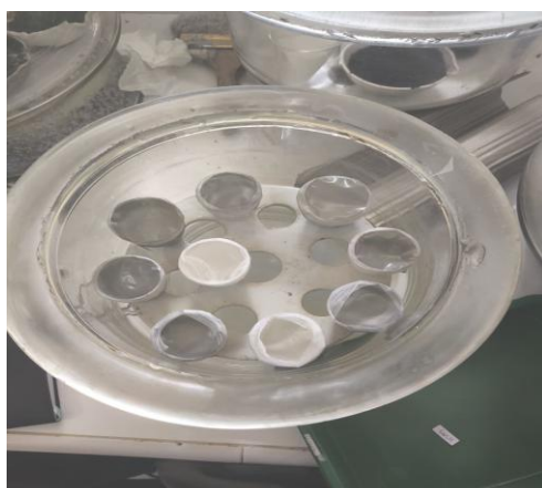
Gambar 8. Pengujian WVTR dalam Desikator
