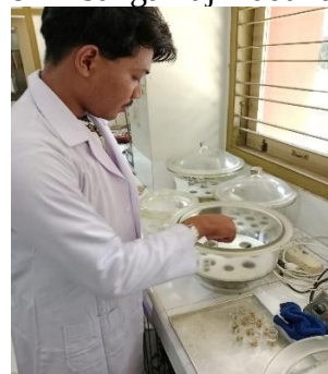
Pendinginan setelah oven di desikator
