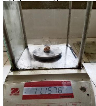
Penimbangan uji kadar air
