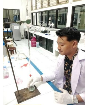
Proses titrasi dengan buret
